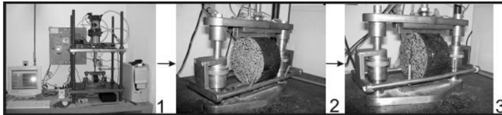
Figura 5. Ensayo de Fatiga por compresión diametral.
